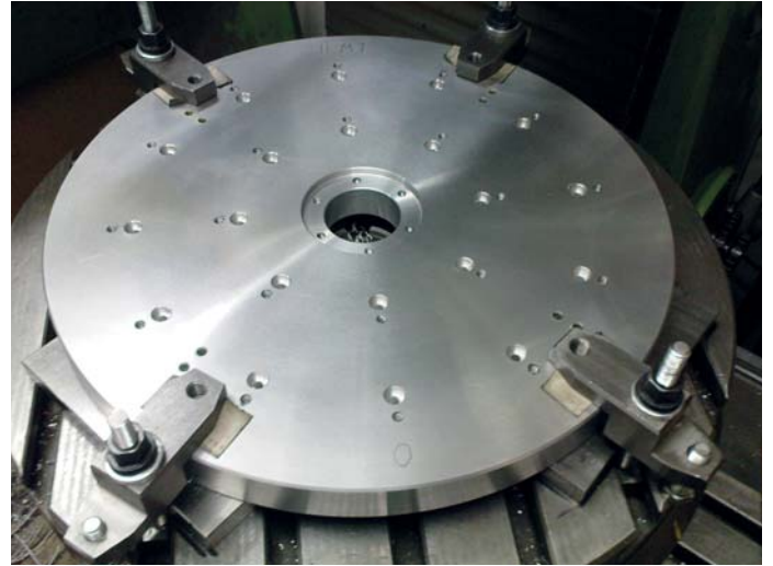
Präzision, soweit das Auge reicht: 15 fertige Passbohrungen
