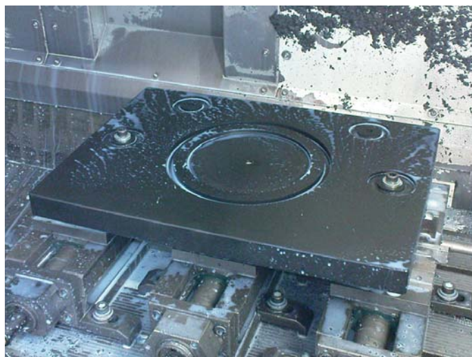
Perfekt und reproduzierbar: CNC-Fertigung des CORIAN-Chassis
